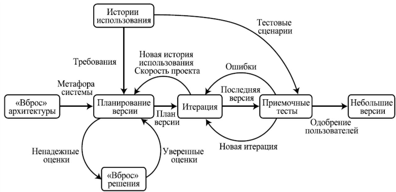
Рис. 28. Схема потока работ в XP
