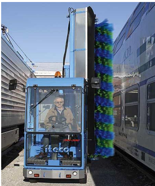
Рисунок 1 Передвижная моечная установка, оборудованная двухцилиндровым двигателем с воздушным охлаждением.
