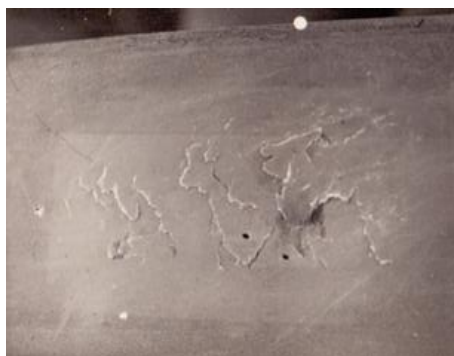
Рис. 1 Выщербины усталостного типа на поверхности катания вагонных колес
