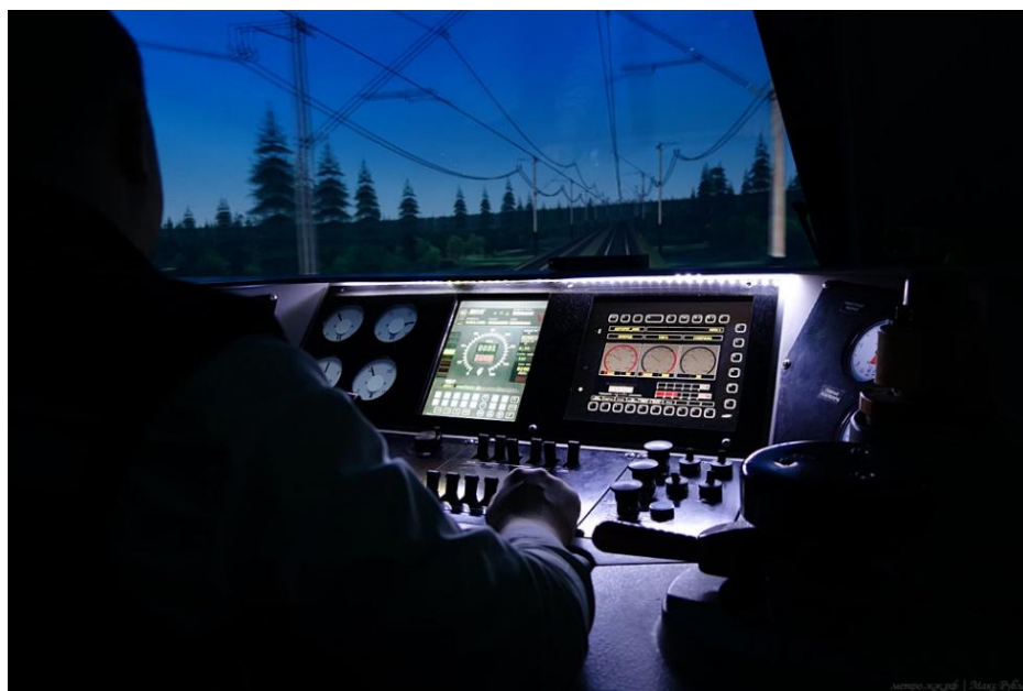
Рис. 3 Кабина машиниста электровоза ЭП1М
