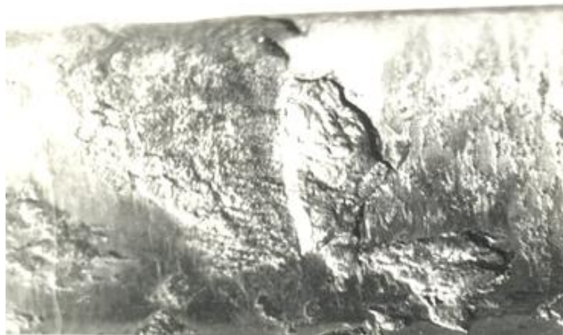
Рисунок 1 – Поверхность зуба тяжелонагруженной зубчатой передачи с характерными видами износа
