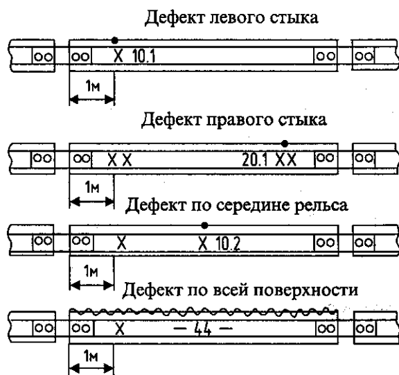
Рис. 1. Схемы маркировки дефектных и остродефектных рельсов
