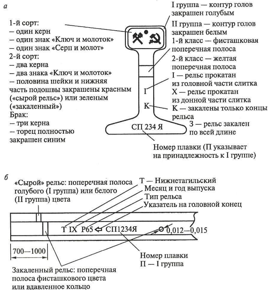
Рис.5 Маркировка новых рельсов: а — в торце рельса; б — вдоль рельса
