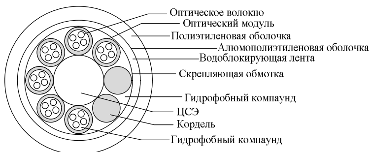
Рисунок 2.2 - Конструкция кабеля типа ОКЛ
