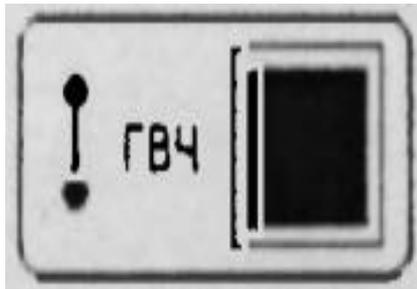
Генератор высокой частоты. Вырабатывает прямоугольные импульсы частотой 1...5кГц.
