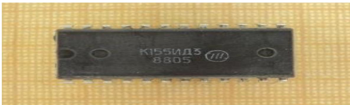
Микросхема представляет собой дешифратор-демультиплексор 4 линии на 16. Содержит 225 интегральных элементов.
