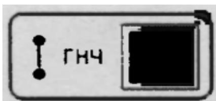
Генератор низкой частоты. Вырабатывает прямоугольные импульсы частотой 1...2Гц.
