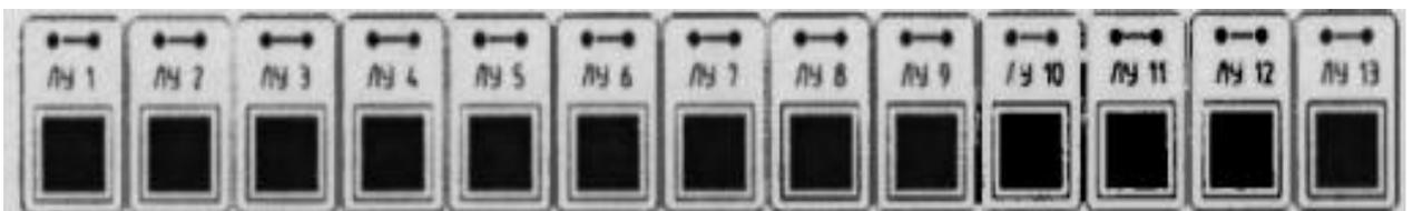
Источники логических уровней. Если кнопка источника нажата, то в двух его выходных гнездах действует уровень логической единицы. Об этом свидетельствует свечение встроенного в кнопку индикатора.
