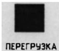
Индикатор перегрузки и кнопка, позволяющая отключить звуковой сигнал.
