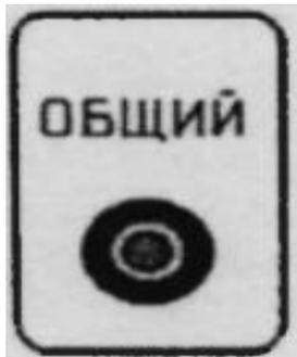
Гнездо для подключения общего вывода входного кабеля осциллографа.
