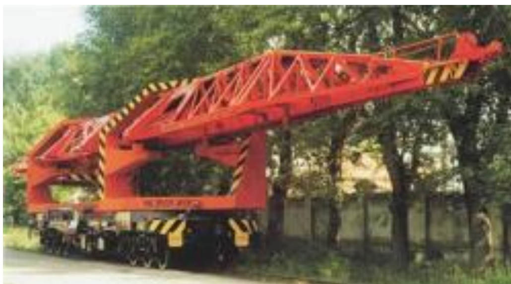
Кран укладочный УК -25СП
