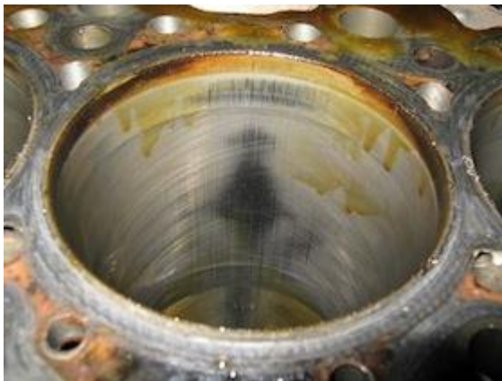
Рисунок №3 - Износ стенки цилиндра
