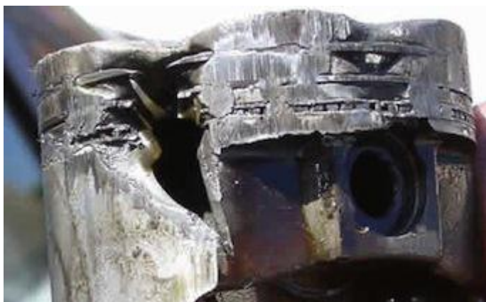
Рисунок №5 - Раплавление поршня в следствии перегрева
