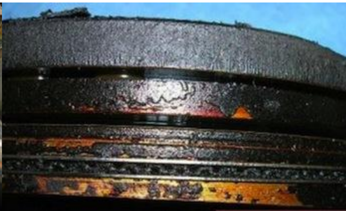
Рисунок №4 - Нагарообразование и залегание поршневых колец
