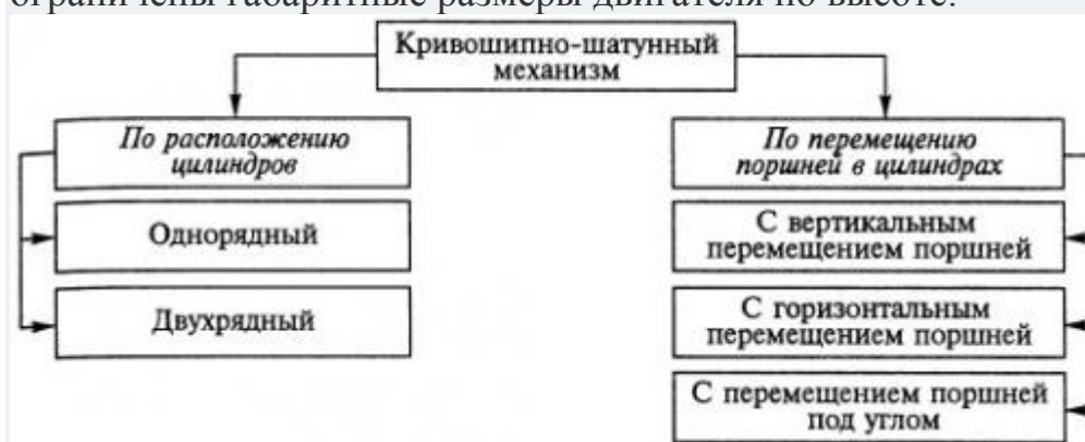
Рисунок 1 – Типы кривошипно-шатунных механизмов, классифицированных по различным признакам.
