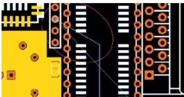
Рисунок 1.1 - Анализ наводок в соседних проводниках при прокладке трассы в пакете Expedition PCB
