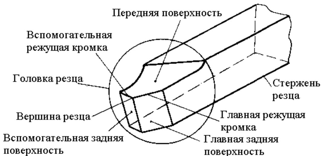
Рис. 11. Элементы токарного резца
