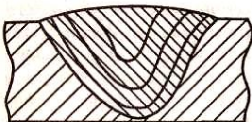
Рис. 28. Схема химической неоднородности по слоям кристаллизации в сварных швах
