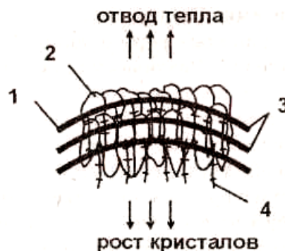
Рис. 55. Схема роста кристаллитов: 1 – граница сплавления; 2 – зерна основного металла; 3 – кристаллизационные слои; 4 – растущие кристаллиты
