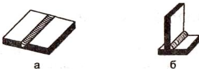
Рис. 40. Стыковой (а) и угловой (б) сварные швы
