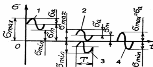
Рис.1. Виды циклов и их характеристики: 1 - несимметричный цикл; 2,3 - пульсирующие циклы; 4 - симметричный цикл;
