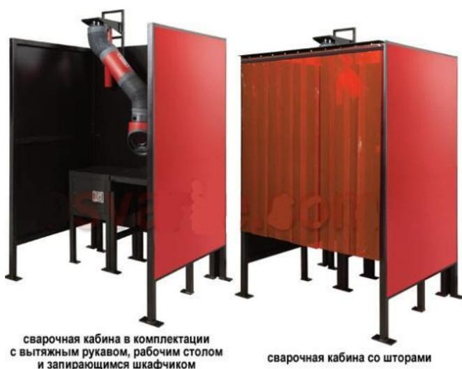
Обычно кабину для такого сварочного поста делают из трех стен, размерами 2х2,5х2 метра. Вход в кабину закрывают куском пропитанного огнестойким составом брезента.
