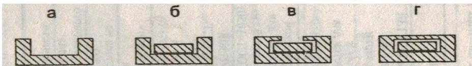
Рис.3 Схема изготовления порошковой ленты
