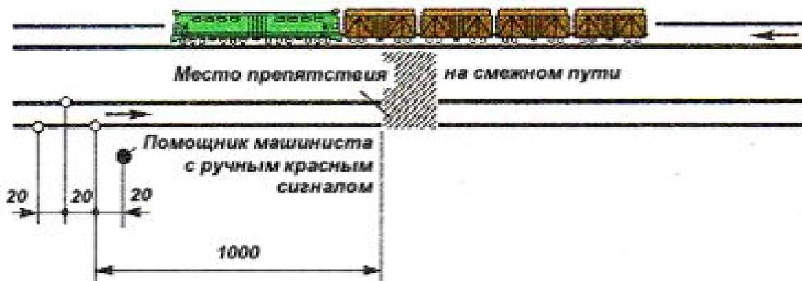
Схема ограждения грузового поезда при вынужденной остановке на перегоне
