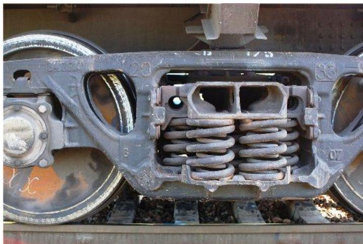
Рис.1 .Общий вид рессорного подвешивания.
