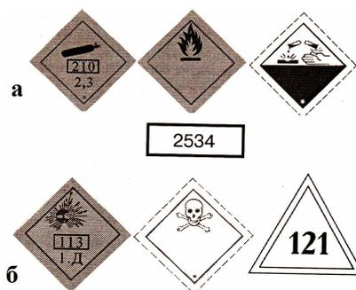
Рисунок 11.4 – Элементы маркировки транспортных средств при перевозке опасных грузов:
