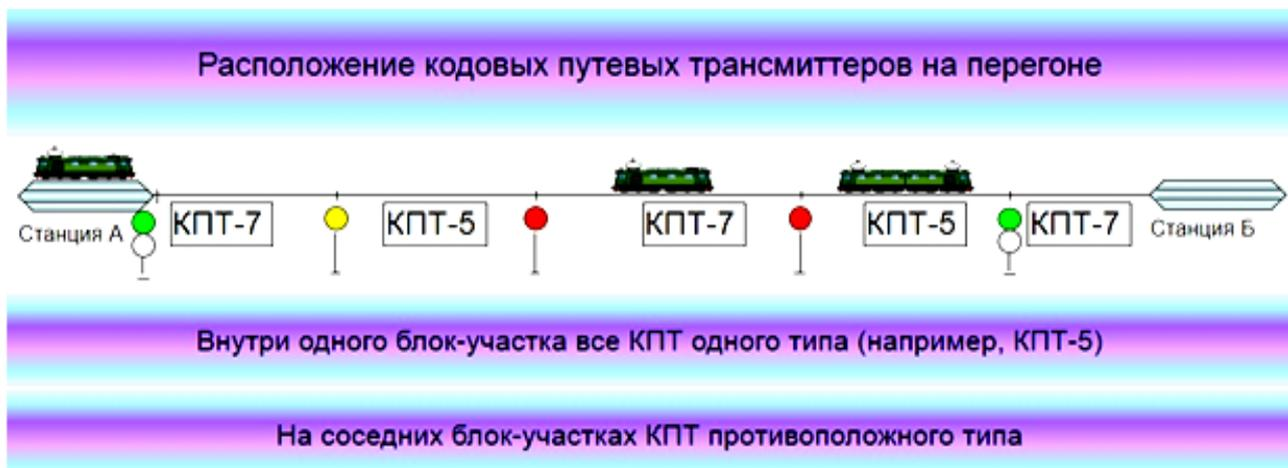
Рисунок 7 – Расположение КПТ на перегоне
