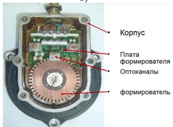
Рисунок 25 – Датчик угла поворота Л1178
