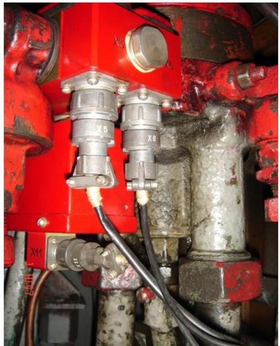
Рисунок 53 – Приставка к крану машиниста электропневматическая ПЭЖМ/485
