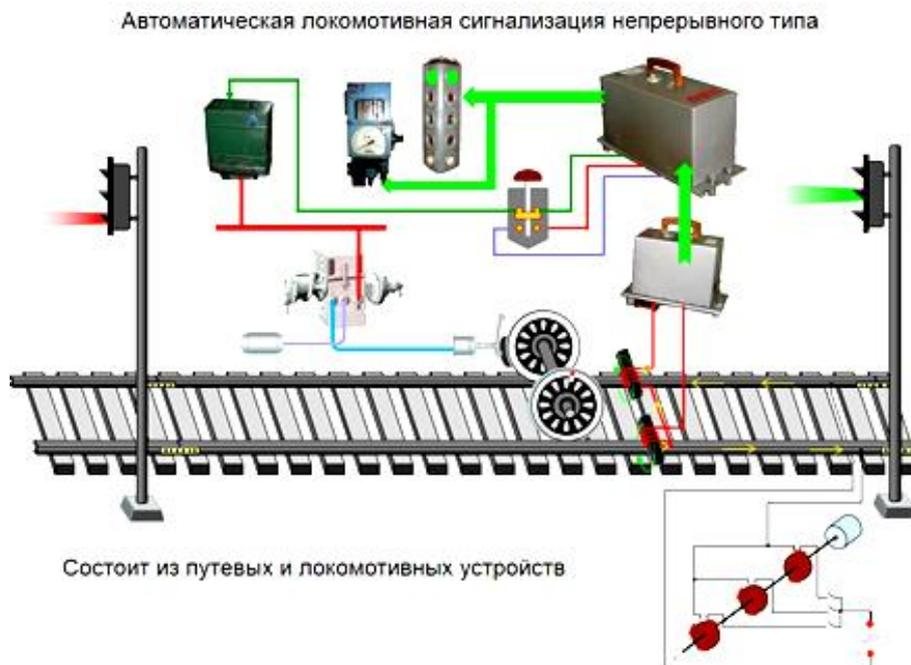
Рисунок 4 – Напольная и локомотивная аппаратура АЛСН.
