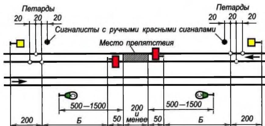
Рисунок 4 - Схема ограждения мест производства работ на перегоне сигналами остановки при фронте работ более 200 м.
