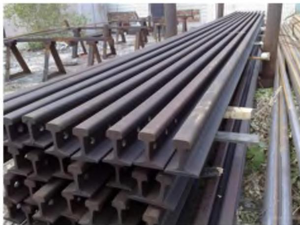
Рисунок 7 – Дифференцированные термоупрочненные рельсы.
