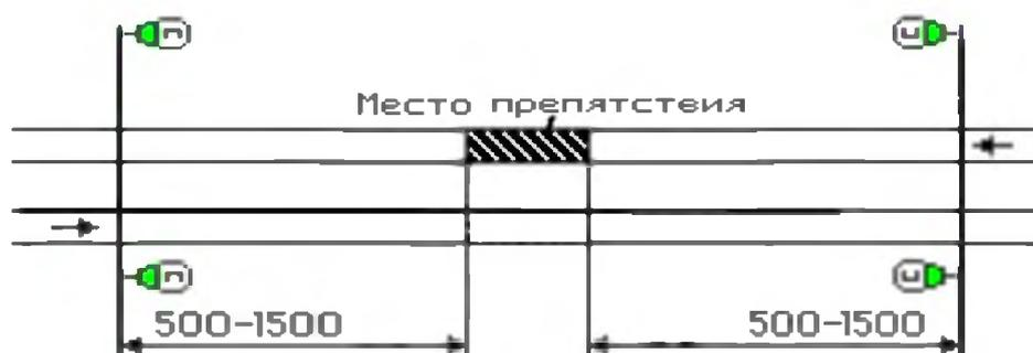
Рис. 2 Ограждение места работ сигналами «свисток»
