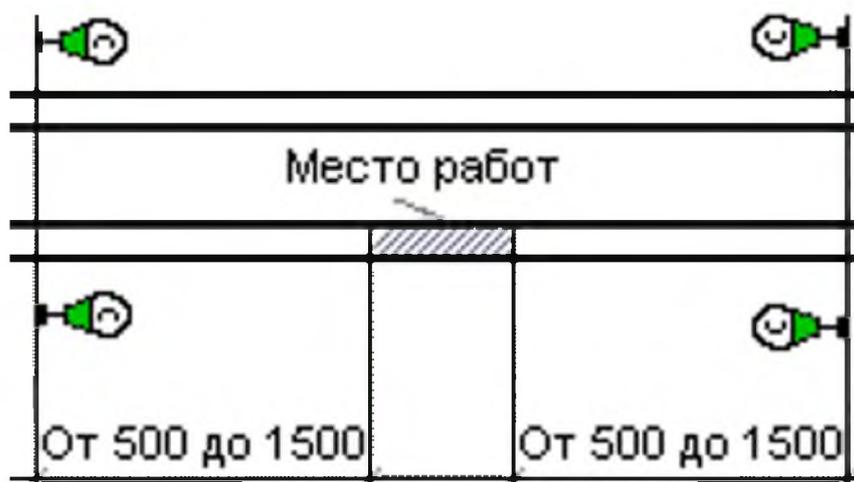
Рисунок 6 - Схема ограждения мест производства работ на перегоне переносными сигнальными знаками «Свисток»
