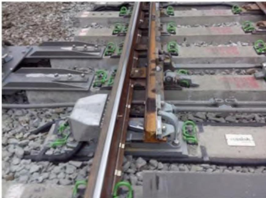
Рисунок 22 - Стрелочный перевод со креплением Vossloh
