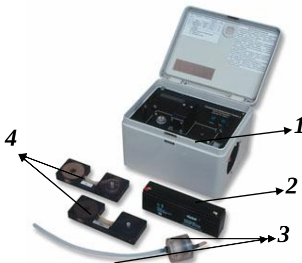
Рис. 2.4. Общий вид газоанализатора с химкассетой и фильтром: 1 – газоанализатор ГАНК-4; 2 – встроенный аккумулятор с зарядным устройством; 3 – воздухозаборный зонд с противопылевым фильтром; 4 – химкасеты
