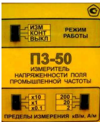
Рис. 11. Панель управления прибора
