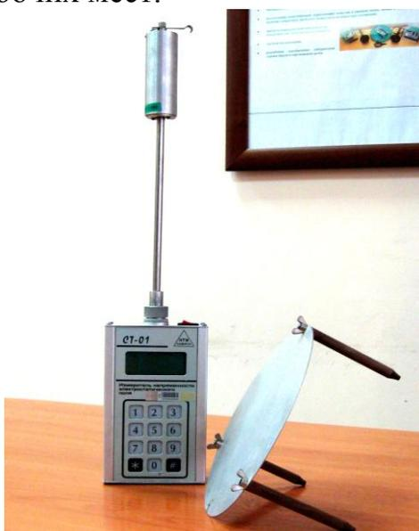
Рис. 3. Измеритель напряженности электростатического поля СТ-01
