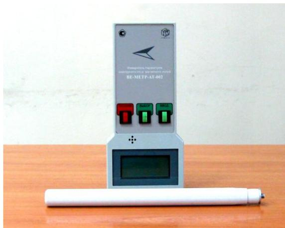
Рис. 1. Измеритель параметров электрического и магнитного полей ВЕ-МЕТР-АТ-002
