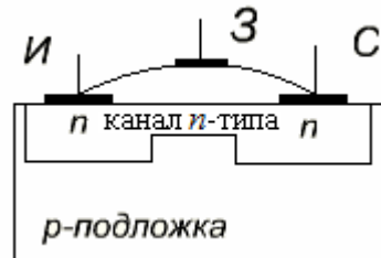
Рис. 4.5. Структура МОП-транзистора со встроенным каналом n -типа
