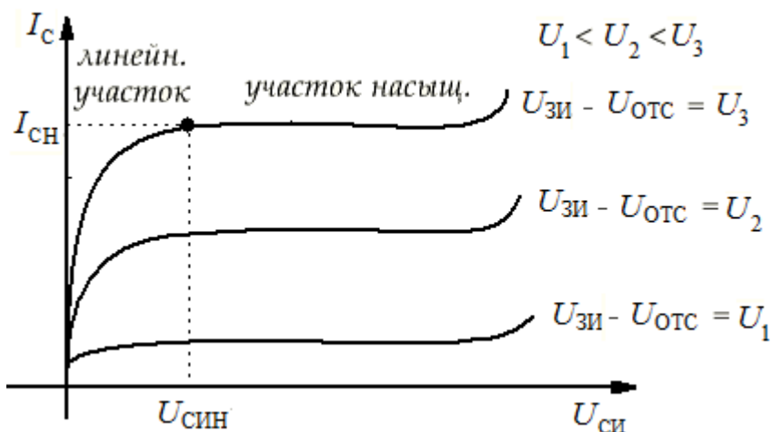
Рис. 4.8. Участки стоковой характеристики МОП-транзистора
