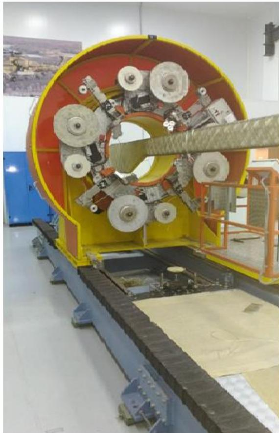
Рисунок 5.1– Общий вид станка для намотки лонжеронов лопастей несущего винта вертолета
