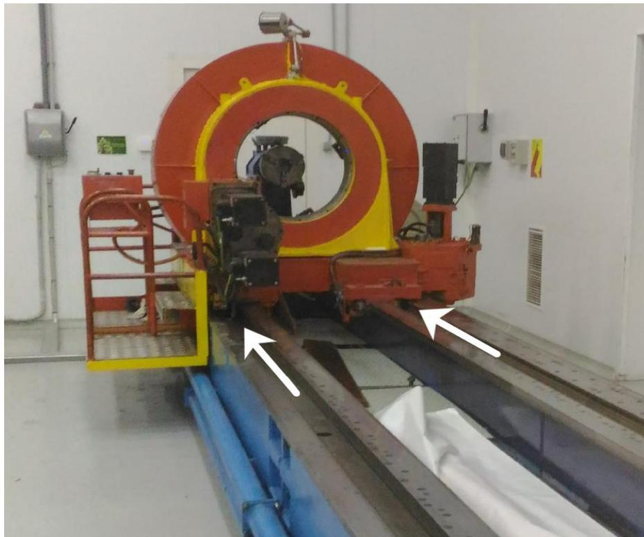
Рисунок 5.2 – Обратная сторона каретки станка для намотки лонжеронов
