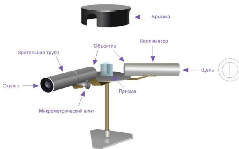
2. Спектроскоп в штативе укрепляется таким образом, чтобы щель его коллиматора была расположена вертикально. Лампа накаливания последовательно с реостатом подключается
