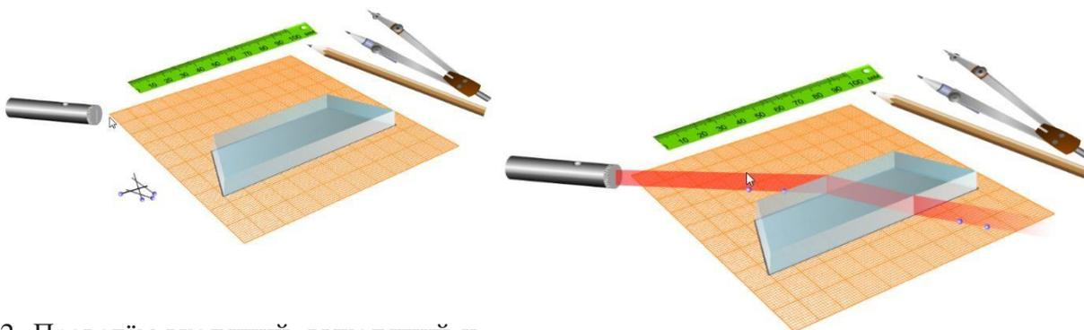
2. Проведём входящий, выходящий и преломлённый лучи и перпендикуляр к границе раздела двух сред. С помощью линейки измерьте отрезки AE и DC.
