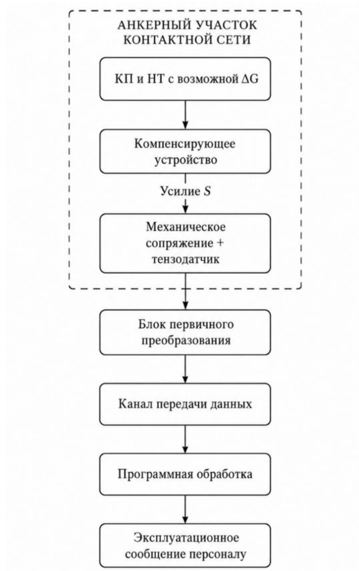
Рисунок 3.3 - Обобщённая структура АСКВП в составе анкерного участка контактной сети
