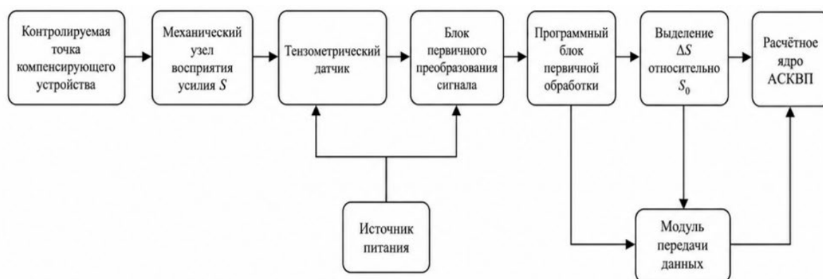
Рисунок 3.2 - Состав измерительного комплекса АСКВП для тензометрического контроля веса проводов контактной подвески
