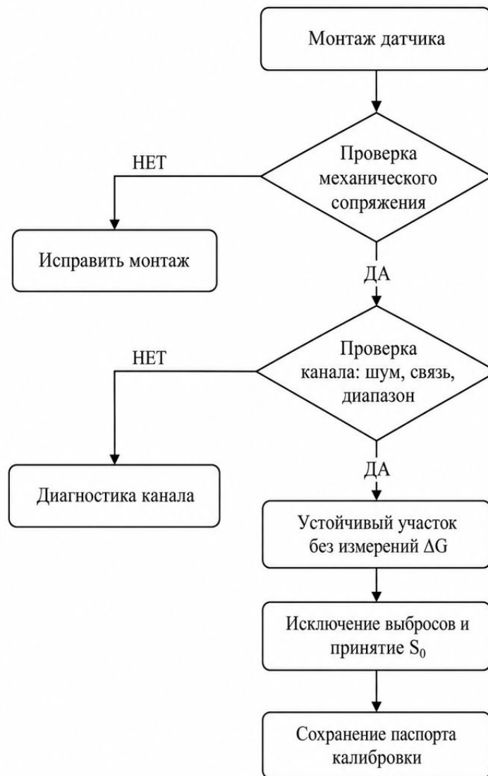
Рисунок 3.6 - Алгоритм калибровки измерительного узла и задания базового уровня S_0 в АСКВП
