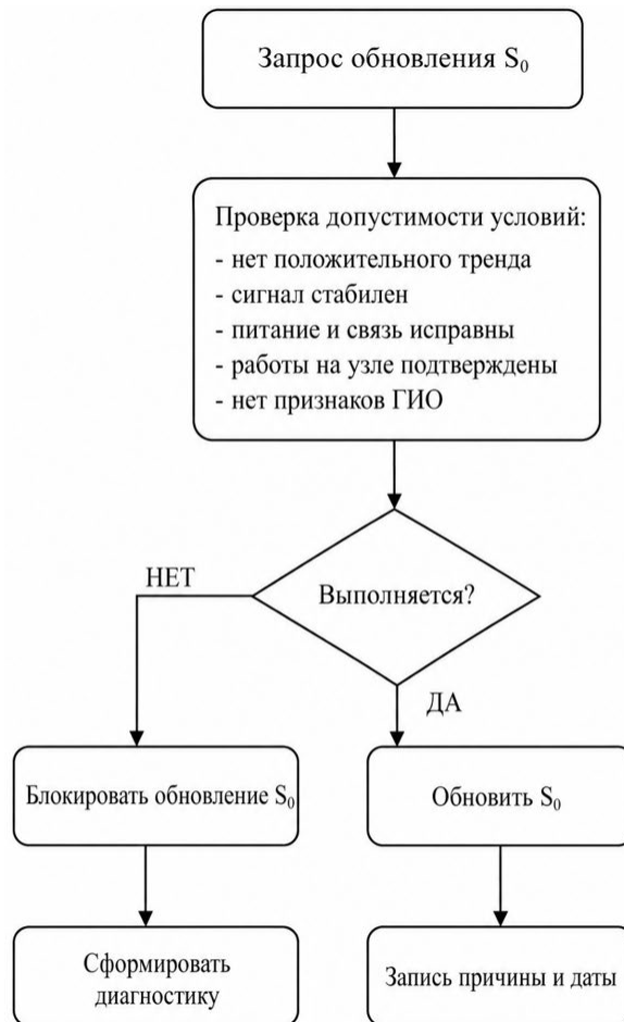
Рисунок 3.7 – Алгоритм проверки допустимости обновления базового уровня S_0
