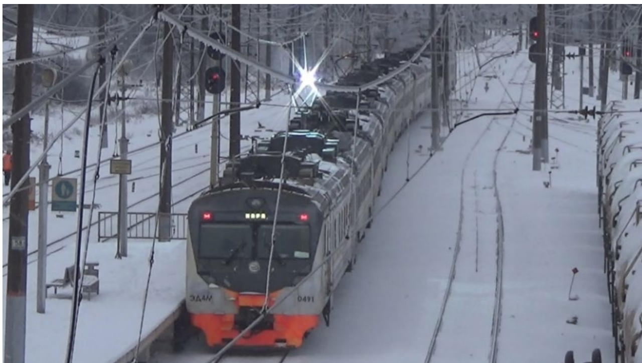
Рисунок 1.1 – Нарушение токосъёма при наличии гололёдно-изморозевых отложений на контактном проводе
