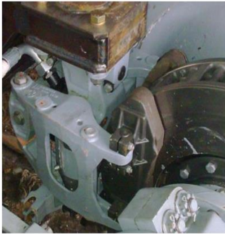
Рисунок 24 – Клещевой тормозной механизм Knorr-Bremse с фрикционными дисковыми накладками
