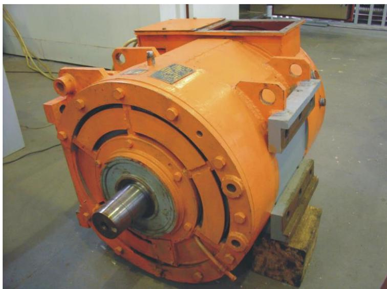
Рис. 4.48. Асинхронный тяговый электродвигатель ДАТ-350-6 УХЛ1
